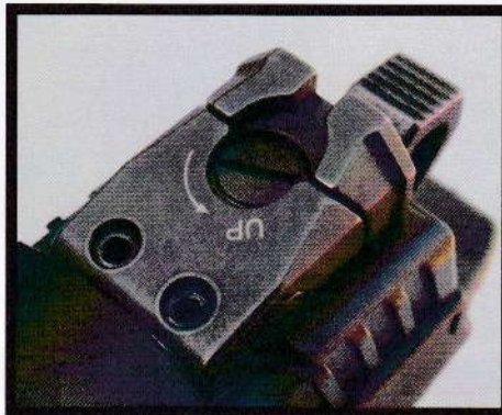
Le guidon, assemblé sur la culasse au moyen d'une queue d'aronde longitudinale et bloqué par une vis, peut être aisément remplacé.
