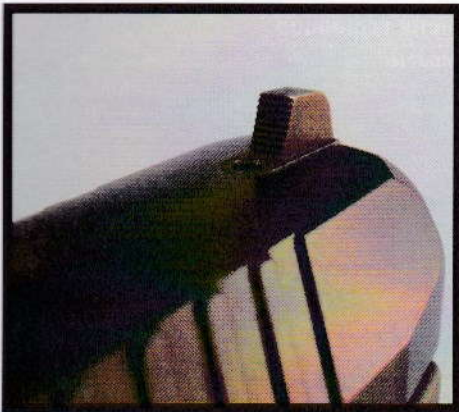
Le guidon, assemblé sur la culasse au moyen d'une queue d'aronde longitudinale et bloqué par une vis, peut être aisément remplacé.
