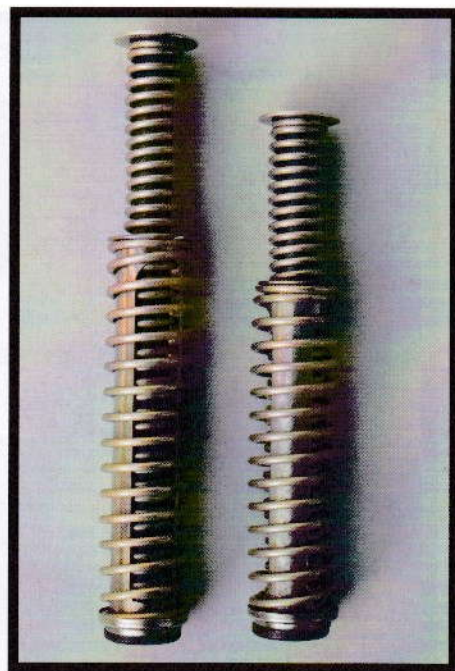
Si le système télescopique combinant deux ressorts hélicoïdaux imbriqués apparu sur le Gen4 a été conservé, les nouveaux ressorts récupérateurs du Gen5 sont nettement plus longs et ils ne sont pas interchangeables avec ceux des générations précédentes.
