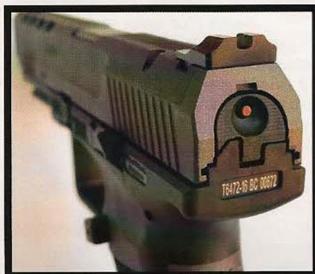
Lorsqu'elle apparaît à l'arrière de la glissière, l'extrémité du percuteur peinte en rouge indique très clairement que le mécanisme est armé.
