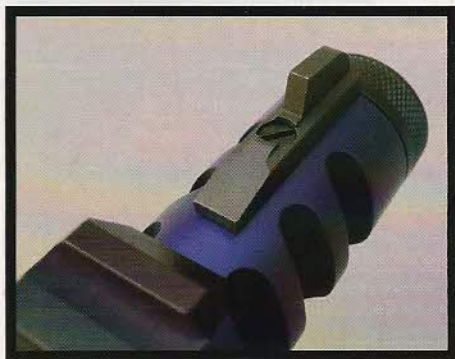
Le guidon en acier, de type Patridge, est solidaire de sa rampe, laquelle est fixée par une vis à l'extrémité antérieure du boîtier en aluminium.
