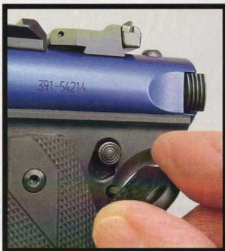
Réalisé de façon à la fois simple et ingénieuse, le système de verrouillage anti-tiers consiste à condamner le poussoir de sûreté en position enclenchée.
