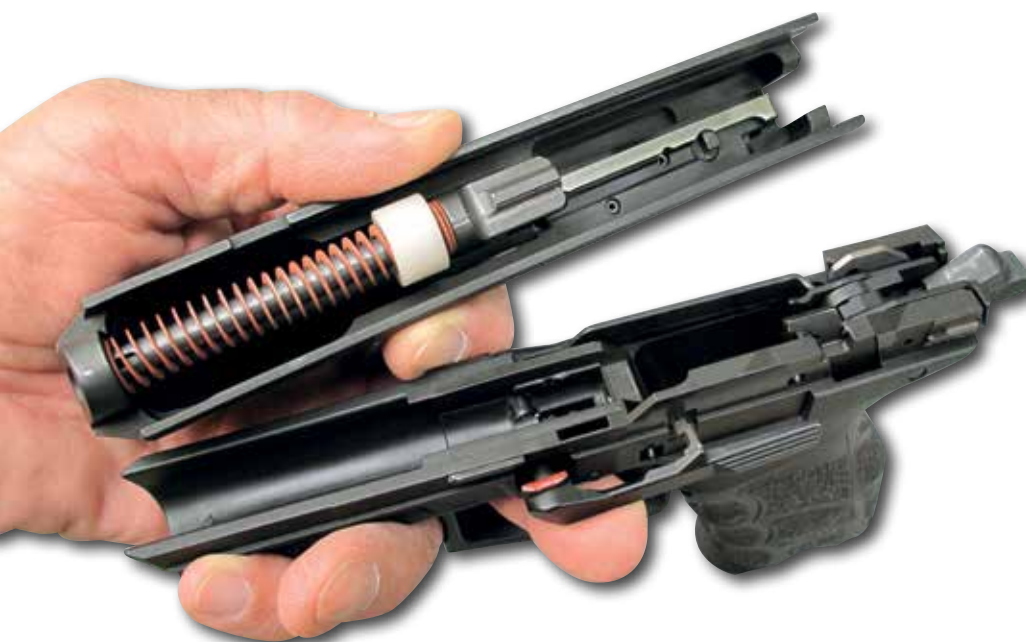
Il suffit de dégager partiellement le levier arrêteur de culasse de son logement pour procéder au démontage instantané de l'arme. On notera le trait de peinture rouge qui indique clairement que le levier n'occupe plus sa position habituelle.
