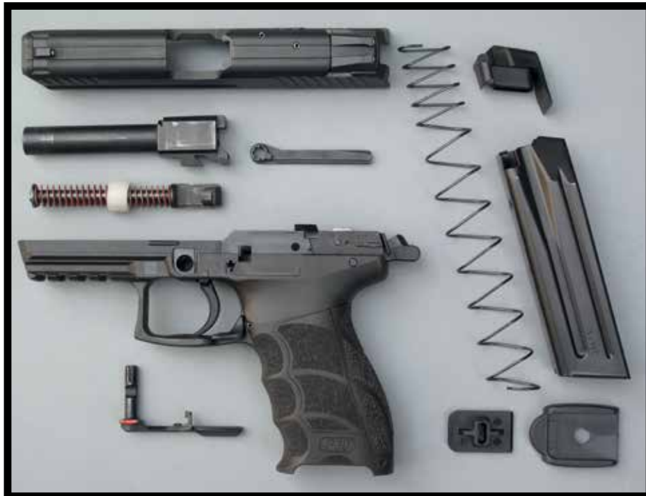
Le démontage sommaire est extrêmement facile à réaliser et ne nécessite aucun outillage. Nous avons ici déposé les deux éléments du levier arrêteur de culasse ambidextre.
