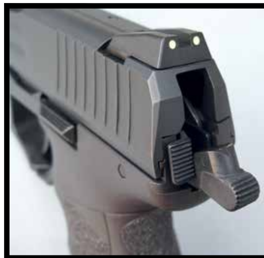
Le poussoir de désarmement jouxte le flanc gauche du marteau, une position inhabituelle qui se révèle parfaitement appropriée pour un utilisateur droitier.
