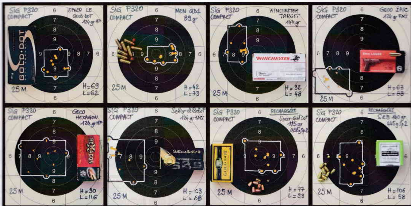
Les groupements, réalisés sur appui à la distance de 25 mètres avec le modèle Compact témoignent de la précision en cible tout à fait satisfaisante de cette arme de combat.
