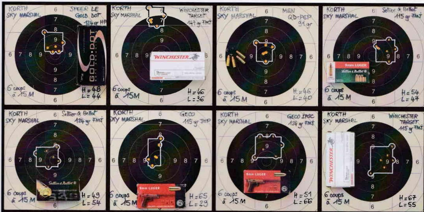
Les groupements de six coups que nous avons réalisés avec des munitions manufacturées à quinze mètres, distance réaliste pour une arme essentiellement destinée à la défense personnelle, démontrent l'excellente précision de ce revolver à canon de deux pouces.
