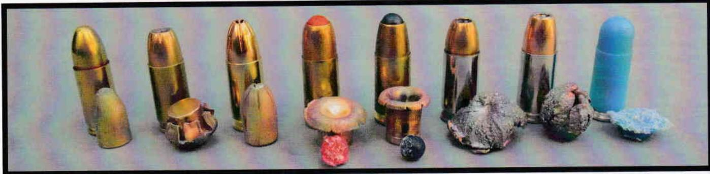
Voici les diverses munitions manufacturées que nous avons testées dans cette arme, accompagnées du projectile récupéré dans un bac de sable gorgé d'eau (de gauche à droite) : Sellier & Bellot 115 gr FMJ, Geco 115 gr HP, Geco Hexagon 124 gr HP, Men QD-1 89 gr ballistic tip, Men QD-PEP 91 gr ballistic tip, PMC Eldorado Starfire 124 gr JHP, Speer Gold Dot 124 gr GDHP, Geco Plastic Training.
