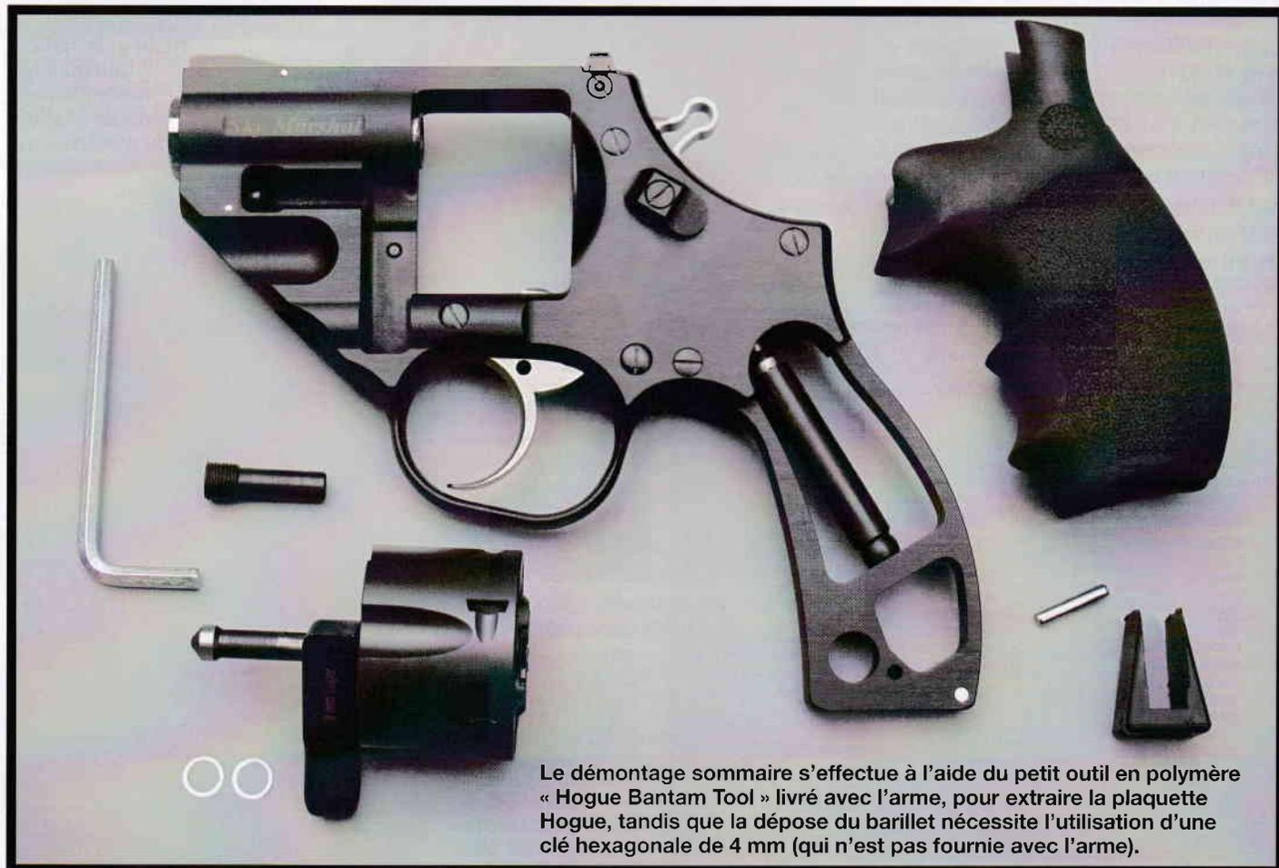
Le démontage sommaire s'effectue à l'aide du petit outil en polymère « Hogue Bantam Tool » livré avec l'arme, pour extraire la plaquette Hogue, tandis que la dépose du barillet nécessite l'utilisation d'une clé hexagonale de 4 mm (qui n'est pas fournie avec l'arme).
