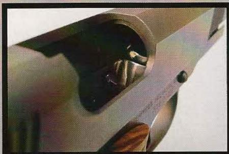
Cette vue, prise à travers la fenêtre d'éjection, permet d'observer l'entrée de la chambre. Le canon de ce pistolet n'est pas rampé, mais on remarquera le soin apporté au polissage de la rampe usinée sur la carcasse.
