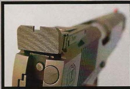
La hausse micrométrique de marque Kensight, réglable en site et en azimut, bénéficie d'un montage abaissé grâce à un usinage de la glissière à la réalisation particulièrement soignée.
