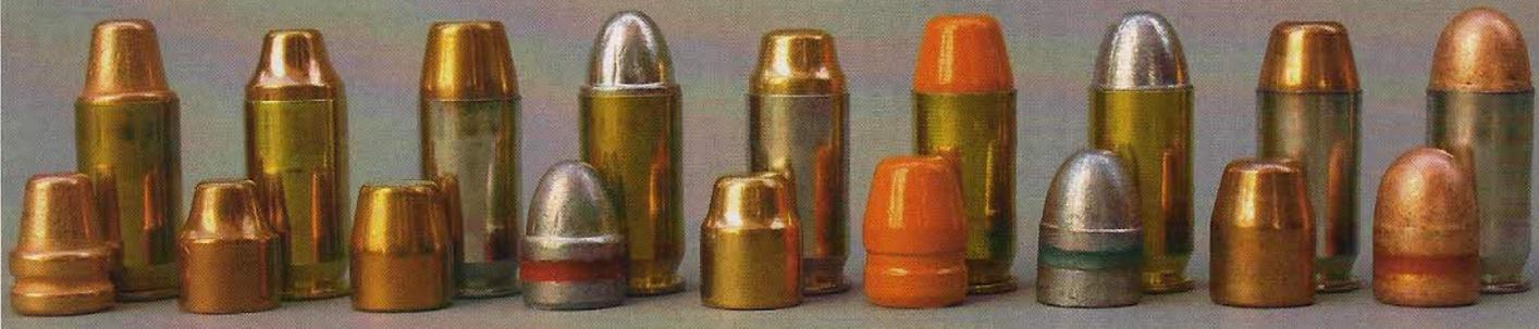
Quelques unes des cartouches que nous avons rechargées pour ce banc d'essai accompagnées de leur projectile, de gauche à droite : MPF 185 grains SWC-TML cuivrée ; IMI 185 grains SWC blindée ; Sierra 185 grains ACP Hollow Cavity ; MPF 200 grains Lead RN ; Focchi 200 grains SWC blindée ; Ares 225 grains peinture époxy ; Balleurope 230 grains Lead RN ; Hornady 230 grains FMJ-FN ; MPF 234 grains RN cuivrée graissée.
