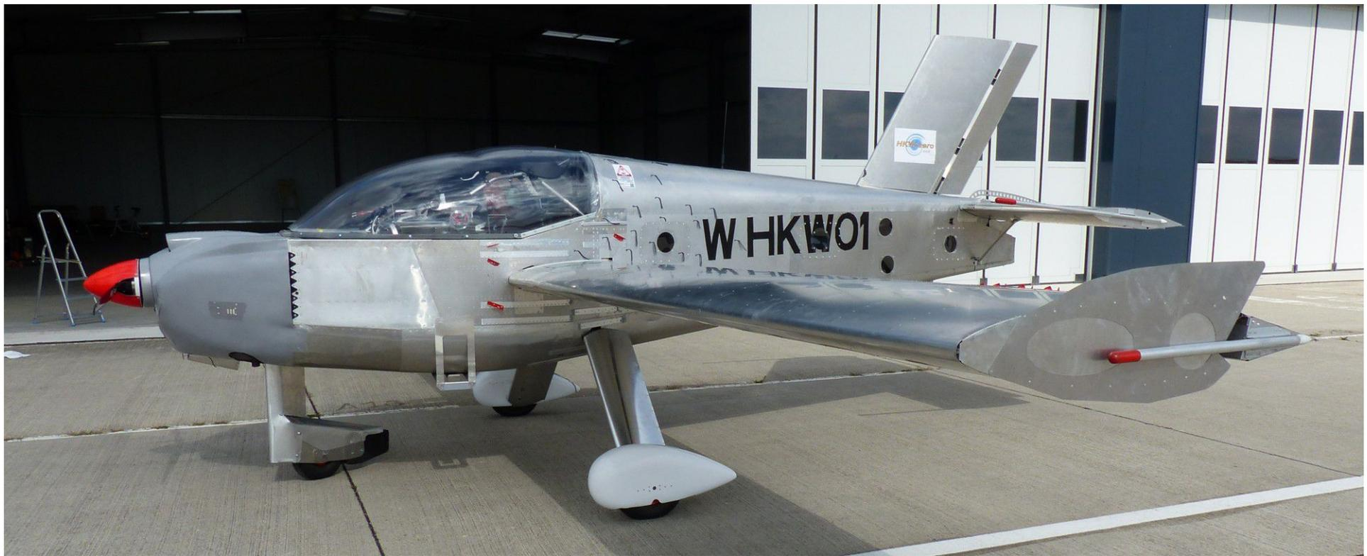
Mise en œuvre des multiples modifications issues de l'analyse des essais en vol de début septembre (à noter les nouveaux turbulateurs, carénages de jambes de train, palettes d'ailerons...)
