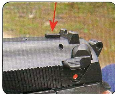
La sécurité du percuteur, qui ne s'efface totalement qu'au moment où la queue de détente est pressée à fond, est ici bien visible (pointée par la flèche).
