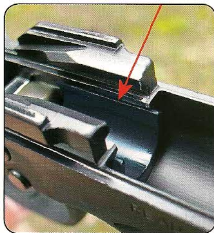
La carcasse de ce nouveau modèle reçoit un amortisseur intégré, réalisé en alliage anodisé bleu, destiné à améliorer la longévité des pièces en atténuant le choc encaissé par la culasse en fin de recul.
