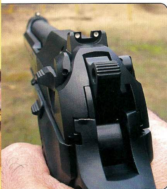
Les éléments de visée présentent des découpes géométriques réalisées avec une remarquable rigueur et sont assistés par trois points blancs dont le contraste est appréciable sur une cible sombre.
