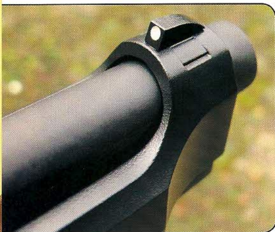
Cette nouvelle version du Beretta 92 adopte le principe du guidon installé à queue d'aronde, ce qui était auparavant l'apanage du modèle 92 FS « Stock ».
