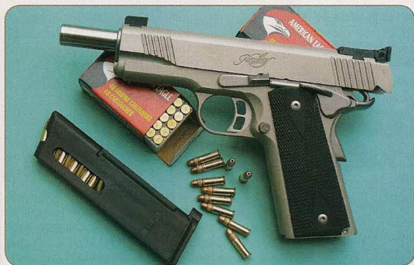
Le chargeur, réalisé en polymère, accueille dix cartouches de calibre .22 Long Rifle.
