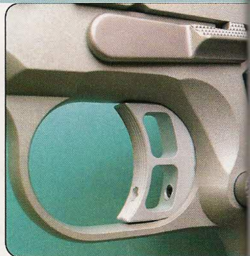
La détente allégée, de type match, comporte une vis permettant de régler le backlash (course morte après décrochement du chien).
