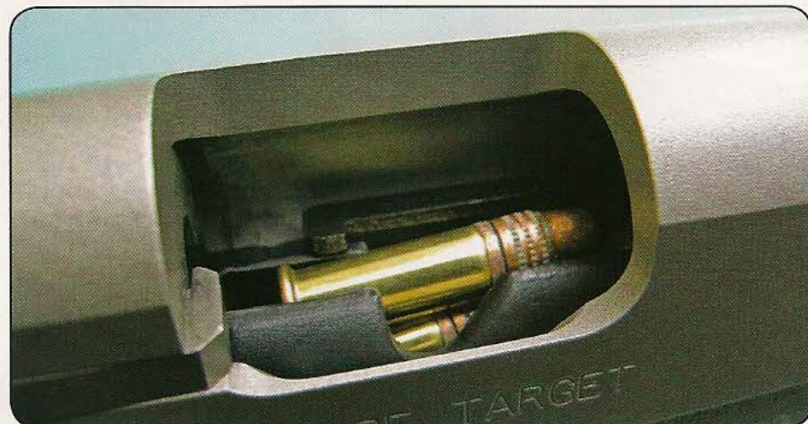
Vue, culasse ouverte, d'une cartouche prête à être chamberée. On remarque, en avant-plan sur le côté gauche, la griffe de l'extracteur et, en arrière-plan, le crochet de l'éjecteur.
