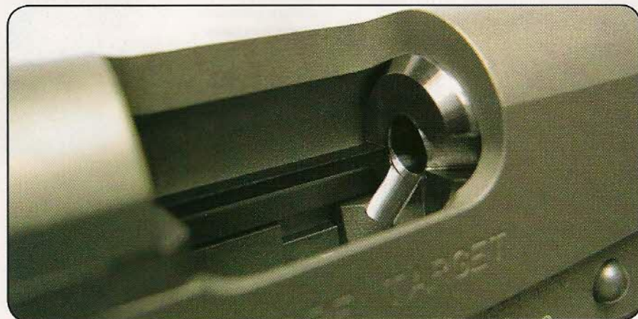
Cette vue permet d'observer, à travers la fenêtre d'éjection, la rampe d'alimentation soigneusement polie qui fait corps avec le canon. On notera au passage l'épaisseur des parois de la culasse à glissière.
