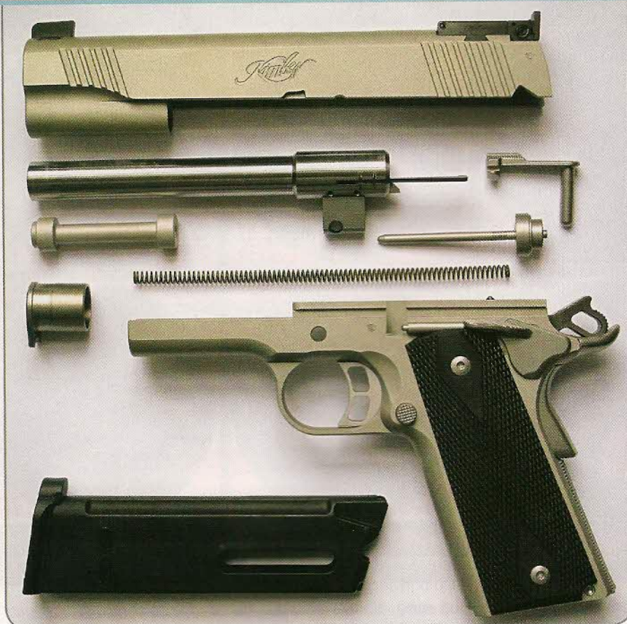
Bien qu'elles présentent parfois une forme un peu différente, on retrouve lors du démontage sommaire toutes les pièces constitutives du Colt 1911 A1.
