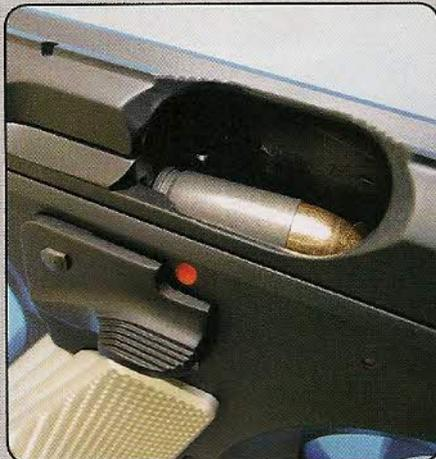
La fenêtre d'éjection présente des rebords soigneusement chanfreinés pour faciliter l'expulsion des douilles vides.
