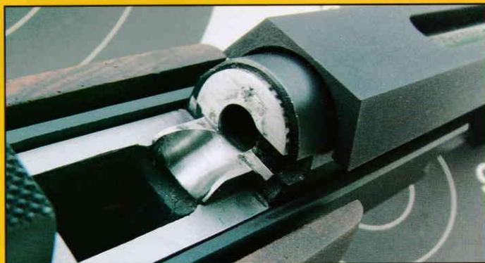
Vue de la rampe d'alimentation, qui guide la cartouche vers la chambre. Le canal creusé sur le côté droit permet à l'extracteur de venir crocheter le bourrelet de la douille.
