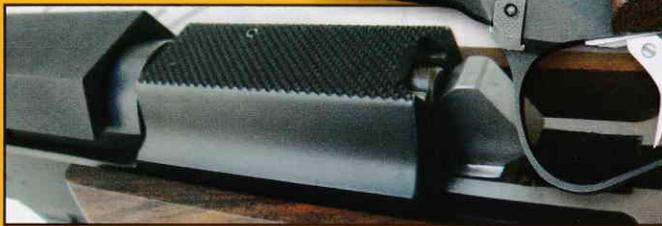
**Le chien externe ne comporte pas de crête d'armement et la culasse, dont la partie supérieure est quadrillée en pointes de diamants, doit être armée à l'aide des encoches pratiquées à l'extrémité antérieure de la glissière.**
