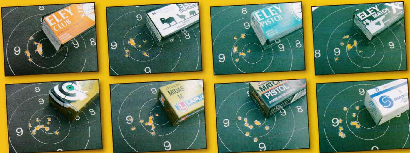
Les groupements de dix coups obtenus à 25 mètres avec différents types de munitions de calibre .22 Long Rifle sont satisfaisants mais peuvent vraisemblablement être améliorés du fait de la difficulté qu'il y a à tester sur appui un pistolet doté d'une crosse anatomique.
