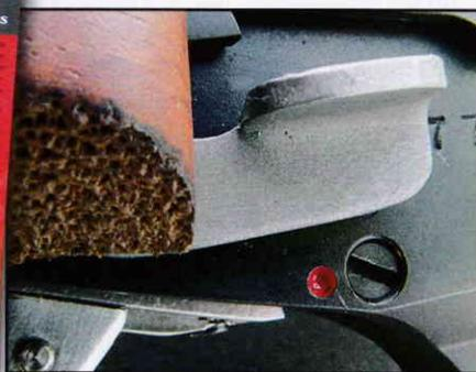
Le levier arrêtoir de culasse, qui fait également office de levier de sûreté grâce à une seconde encoche, fonctionne à l'inverse des leviers conventionnels, puisqu'il convient de le relever pour libérer la culasse.
