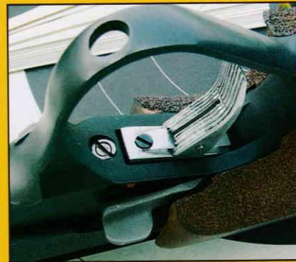
**La queue de détente en aluminium, large de 10 mm, peut être avancée ou reculée, en fonction de la morphologie de l'utilisateur, par coulissement le long de son rail de fixation.**
