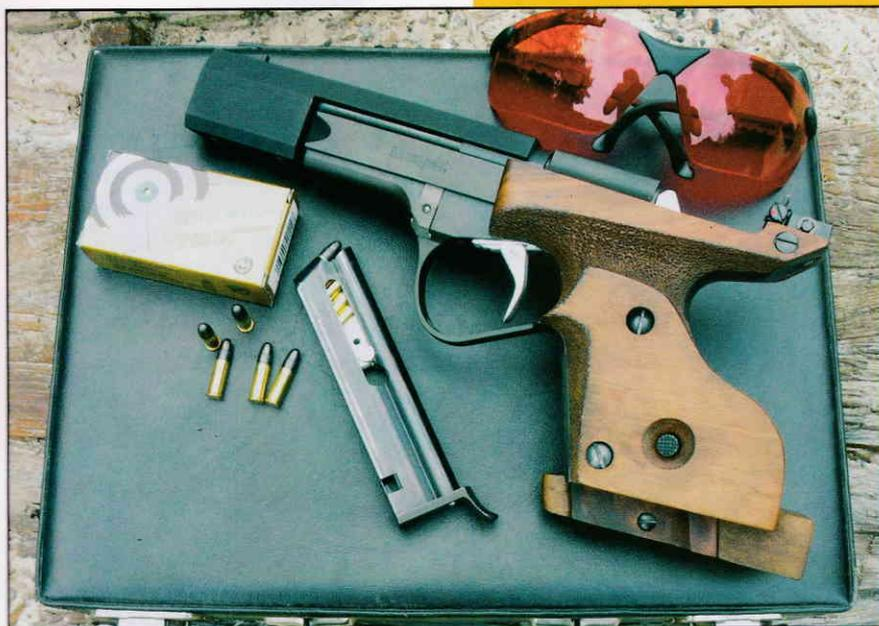
**Le DES/69-U reçoit un chargeur de 5 coups que l'on introduit, de façon classique, par le dessous de la poignée.**
