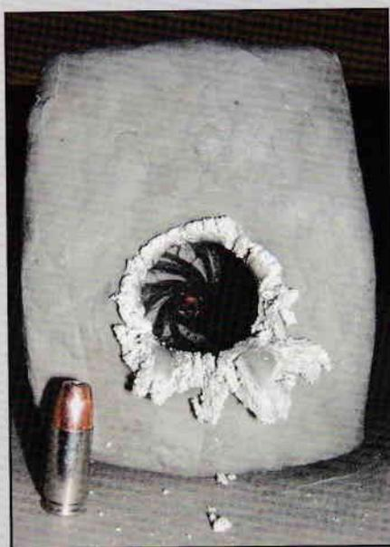
La balle de 115 grains des cartouches manufacturées Speer Gold Dot délivre toute son énergie dans le bloc de plastiline où elle ouvre un tunnel dont le diamètre atteint 40 mm et la profondeur 140 mm ; remarquez l'effet gyroscopique imprimé aux parois de la cavité.
