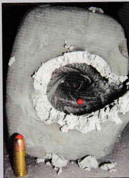
La balle de 89 grains des cartouches manufacturées Men QD1 ouvre dans le bloc de plastiline un tunnel dont le diamètre atteint 45 mm et la profondeur 150 mm ; notez la présence de la pointe balistique en nylon au centre de la cavité.
