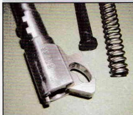
**On remarque la rampe inclinée à profil fermé qui déclenche le déverrouillage du canon et l'on note au passage que la tige-guide du ressort récupérateur est désormais moulée en polymère et non plus usinée en acier.**
