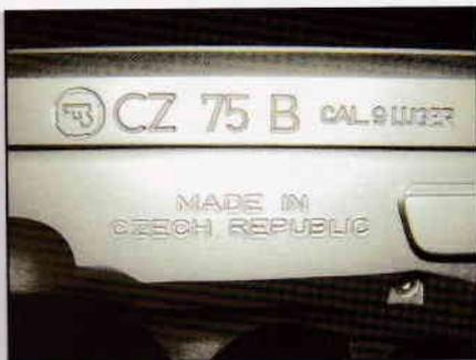
Les marquages d'identification (marque, modèle, calibre et pays d'origine) figurent sur le côté gauche de l'arme, tandis que le numéro de série est porté sur le côté droit des éléments principaux (carcasse, culasse et canon).
