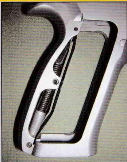
**Goupillée à l'intérieur de la poignée, une lame en acier (que les tireurs de parcours s'empressent d'ôter) crée un frottement afin d'éviter la chute du chargeur vide lorsque le bouton de déverrouillage est actionné.**
