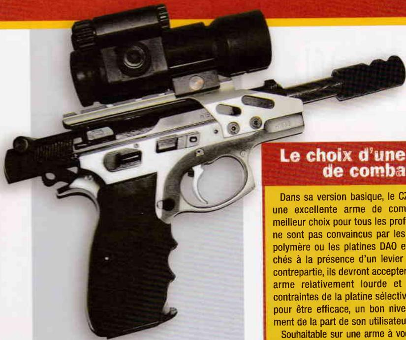
Le modèle Match, réalisé sur la base du CZ-85 en acier au carbone, constitue la version la plus élaborée de la gamme: finition bicolore (bronzage et chrome dur); montage optique; frein de bouche à double chambre; platine préparée avec détente à simple action et butée réglable de backlash.
