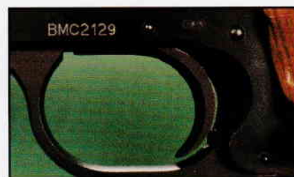
Remarquez la vis de backlash permettant de limiter la course résiduelle de la détente.
