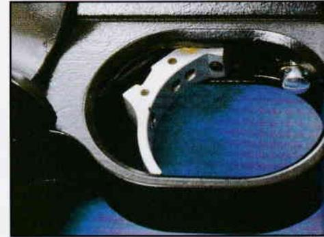
La queue de détente comporte 4 vis Allen permettant de régler, de haut en bas : la pré-course, la bossette, le décrochement et la course résiduelle. La grosse vis située sous le pontet permet d'agir sur la tension de la détente.
