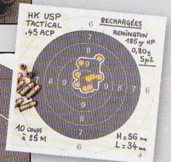
Groupement réalisé à 25 mètres avec des cartouches rechargées au moyen d'une balle semi-wadcutter IMI 185 grains poussée par 0,50 g de A0.
