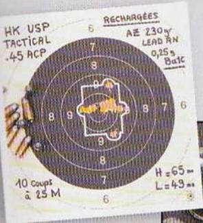
Groupement réalisé à 25 mètres avec des cartouches rechargées au moyen d'une balle coulée AZ 230 grains poussée par 0,25 g de Ba10.
