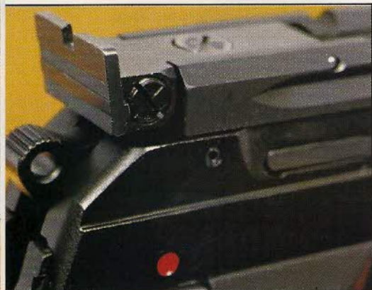
La hausse micrométrique, réglable en site et en azimut, dispose d'une large visière.
