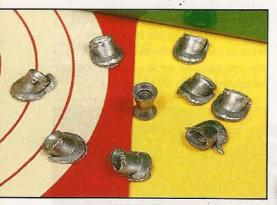
Disposés autour d'un diabolo neuf, les 8 projectiles aplatis récupérés dans le porte cible métallique témoignent de la force des impacts.
