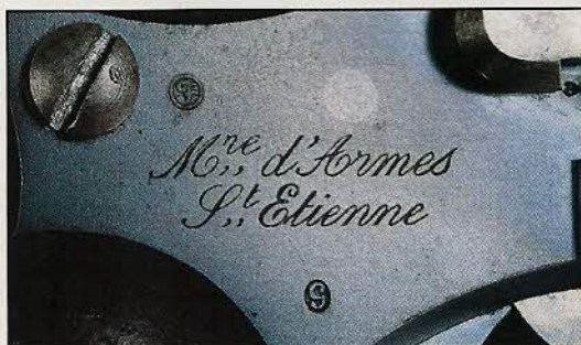
Le marquage de la M.A.S. figure sur le côté droit de la carcasse. Notez la présence des poinçons d'inspection.
