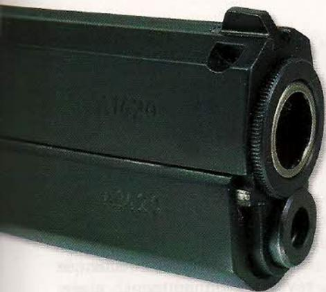
On remarque la présence d'un bushing, vissé dans la culasse et bloqué par le bouchon du ressort récupérateur.
