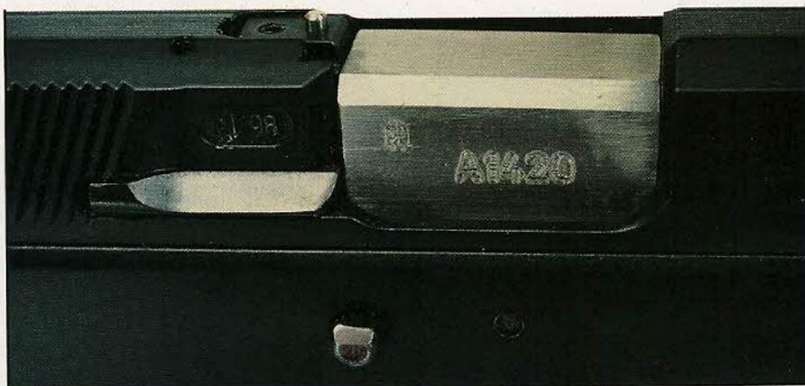
La fenêtre d'éjection adopte une forme carrée largement échancrée, à l'instar des SIG et des Glock. Notez la présence d'un témoin de chargement qui indique, lorsqu'il est saillant, la présence d'une cartouche dans la chambre du canon (c'est le cas sur cette photo).
