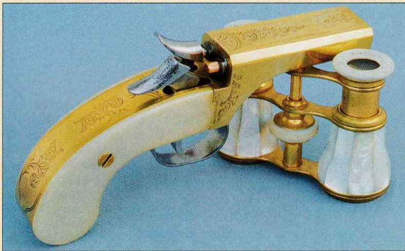
Long de 170 mm et pesant 580 grammes à vide, le Snake Eyes est doté de deux canons lisses de calibre .36 disposés en table. Détail original du mécanisme, la percussion successive des deux chiens est commandée par une queue de détente unique.
