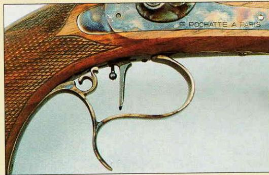
Le pistolet Andrew est muni d'un canon de calibre .36 à 7 rayures à gauche. Il a été doté de tous les attributs disponibles sur les armes de match modernes, tels la hausse micrométrique, la poignée ergonomique et la détente réglable.
