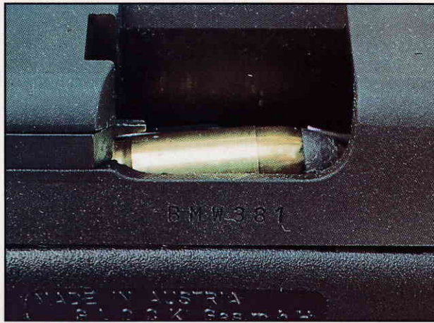
On remarque l'angle plus ouvert que forme la paroi arrière de la fenêtre d'éjection
