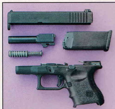
Le démontage sommaire du Glock, comme son remontage, est un jeu d'enfant. Les deux ressorts récupérateurs et leurs tiges guides imbriquées forment un ensemble indissociable.
