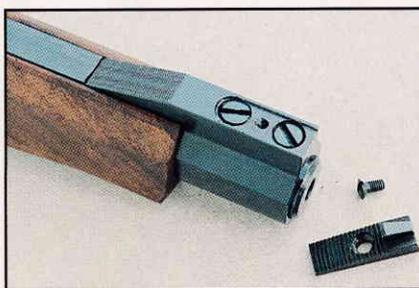
La dépose du guidon permet d'accéder aux deux vis pointeau qui maintiennent l'embouchoir sur le canon.
