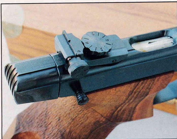
La hausse est réglable sans outil au moyen de deux grosses molettes crantées. Notez la tirette de démontage de la culasse, située sur le côté droit du boîtier.
