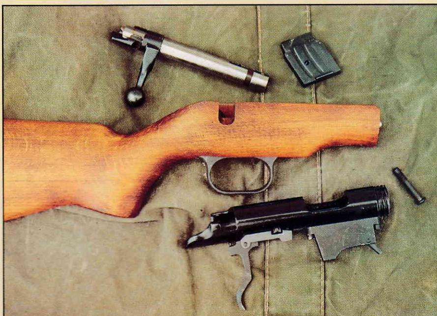
La culasse peut être instantanément extraite. Son boîtier, sous lequel est rattaché le mécanisme de détente et le puits de chargeur, est facilement démontable après avoir retiré la vis antérieure du pontet.
