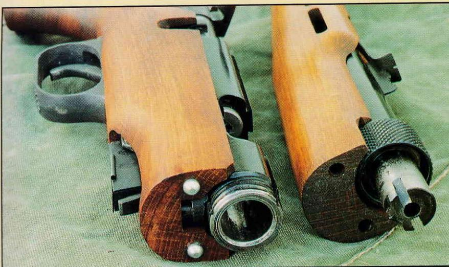
Le canon, dont le tonnerre pénètre par frottement gras, est bloqué par une grosse molette vissée sur le filetage externe de la boîte de culasse. Le centrage est obtenu au niveau du fût, au moyen de deux plots en aluminium.
