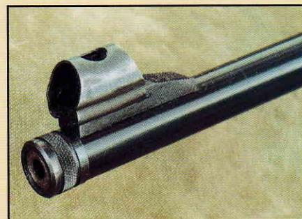
Le guidon est monté sous tunnel. Notez le filetage externe de la bouche du canon, protégé par une bague amovible, destiné à la fixation éventuelle d'un modérateur de son.
