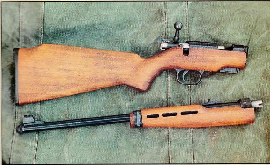
La carabine Commando peut être instantanément démontée en deux éléments compacts, afin d'en réduire l'encombrement lors du transport et du stockage
