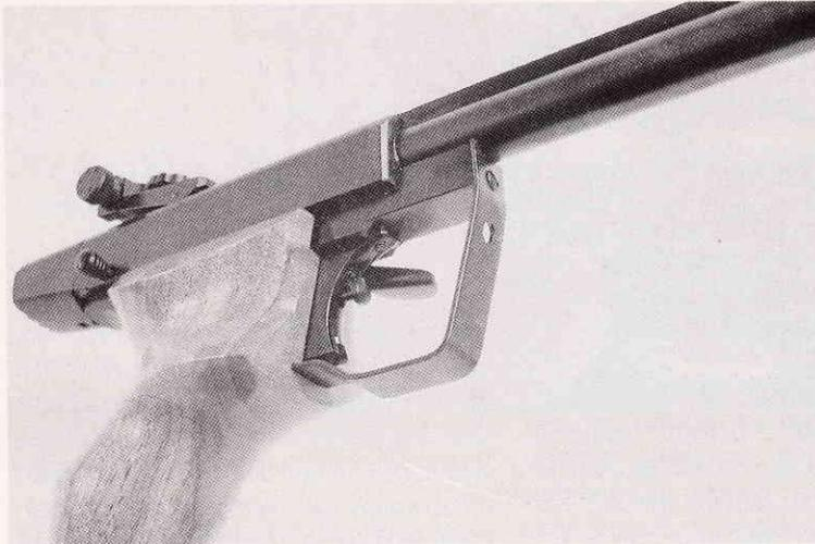
*La détente du Drulov est actionnée par un petit bouton poussoir. L'armement du mécanisme de détente est obtenu à l'aide d'un levier situé sur le côté gauche. Un trou percé à travers le pontet permet d'accéder à la vis de réglage.*
