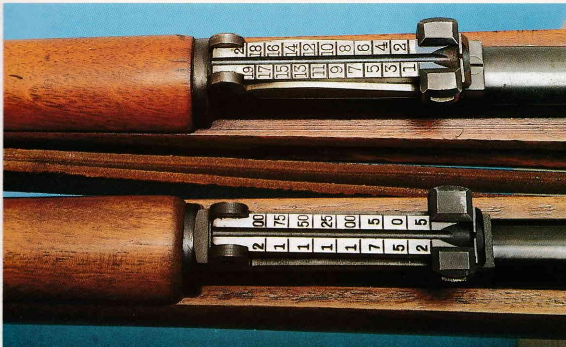
La hausse à curseur de la copie chinoise (au-dessous) est graduée de 25 à 200 mètres. Celle du modèle d'époque est graduée de 100 à 2000 mètres, ce dernier chiffre étant la limite de la portée utile de son calibre 7,92 mm.
